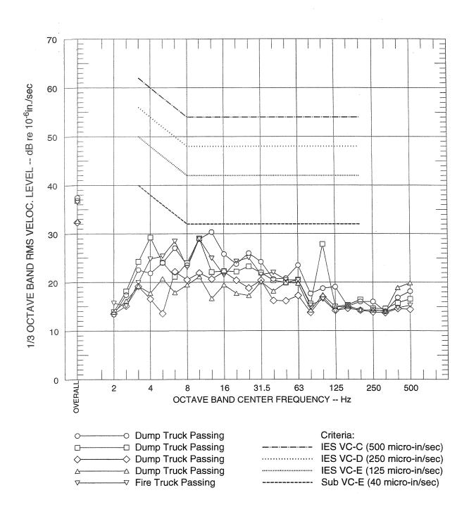
FIGURE 6C SINGLE-EVENT VIBRATION LEVELS AT POSITION 2 CH.3 - HORIZONTALLY PERPENDICULAR TO BEAM HALL (TRANSVERSE) STREET LEVEL - WEST
