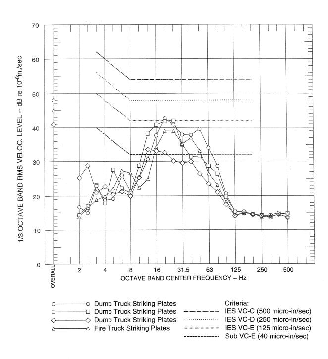
FIGURE 7C SINGLE-EVENT VIBRATION LEVELS AT POSITION 2 CH.3 - HORIZONTALLY PERPENDICULAR TO BEAM HALL (TRANSVERSE) STREET LEVEL - WEST
