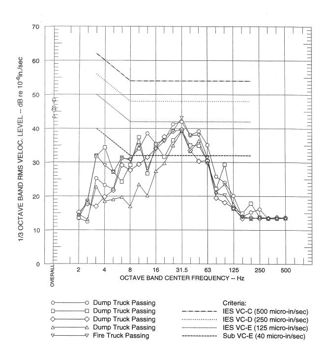
FIGURE 6A SINGLE-EVENT VIBRATION LEVELS AT POSITION 2 CH.1 - VERTICALLY PERPENDICULAR TO BEAM HALL STREET LEVEL - WEST
