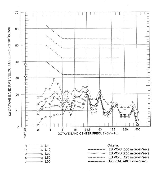
FIGURE 1B STATISTICAL VIBRATION LEVELS AT POSITION 1 CH.2 - PARALLEL TO BEAM HALL STREET LEVEL - EAST
