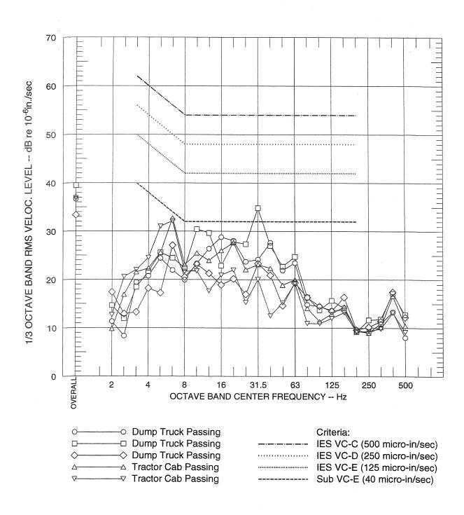
FIGURE 4B SINGLE-EVENT VIBRATION LEVELS AT POSITION 1 CH.2 - PARALLEL TO BEAM HALL STREET LEVEL - EAST
