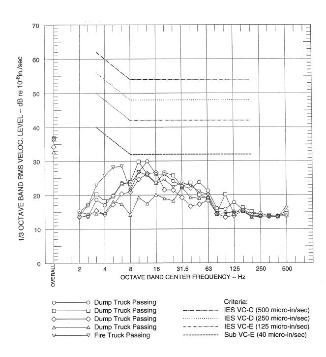
FIGURE 6B SINGLE-EVENT VIBRATION LEVELS AT POSITION 2 CH.2 - PARALLEL TO BEAM HALL STREET LEVEL - WEST
