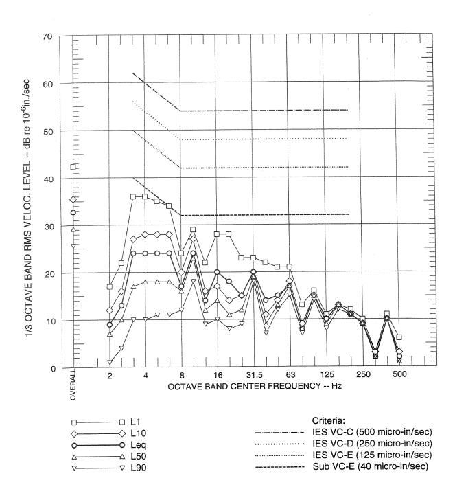
FIGURE 2C STATISTICAL VIBRATION LEVELS AT POSITION 2
