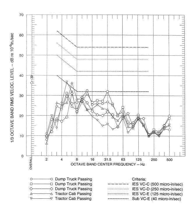
FIGURE 4C SINGLE-EVENT VIBRATION LEVELS AT POSITION 1 CH.3 - HORIZONTALLY PERPENDICULAR TO BEAM HALL (TRANSVERSE) STREET LEVEL - EAST
