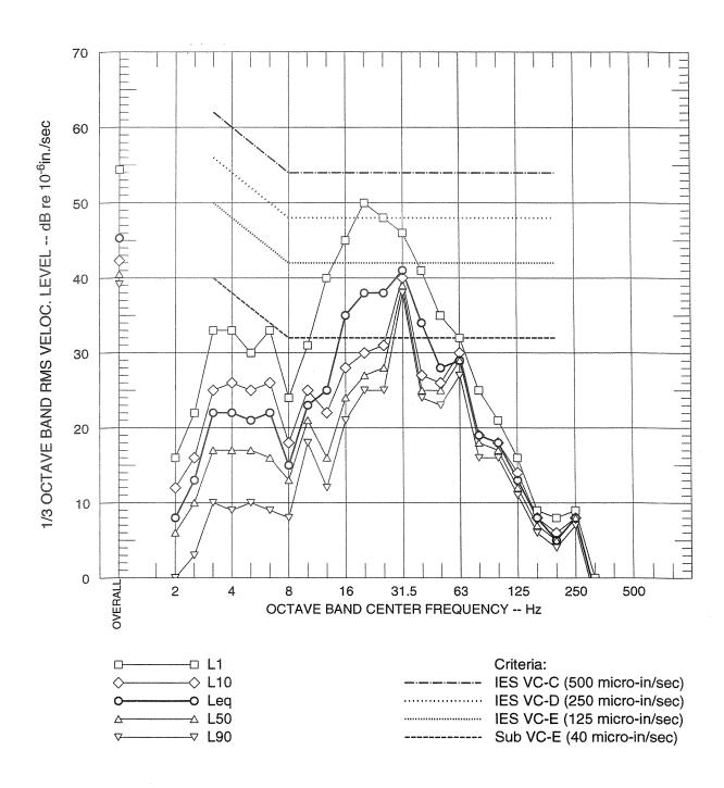
FIGURE 2A STATISTICAL VIBRATION LEVELS AT POSITION 2 CH.1 - VERTICALLY PERPENDICULAR TO BEAM HALL STREET LEVEL - WEST
