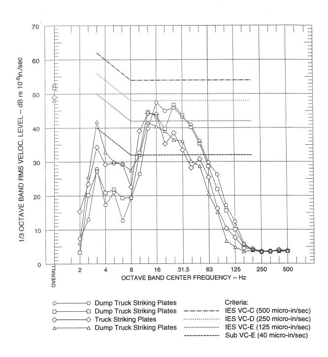
FIGURE 9A SINGLE-EVENT VIBRATION LEVELS AT POSITION 3 CH.1 - VERTICALLY PERPENDICULAR TO BEAM HALL LOWER LEVEL - INJECTOR HALL
