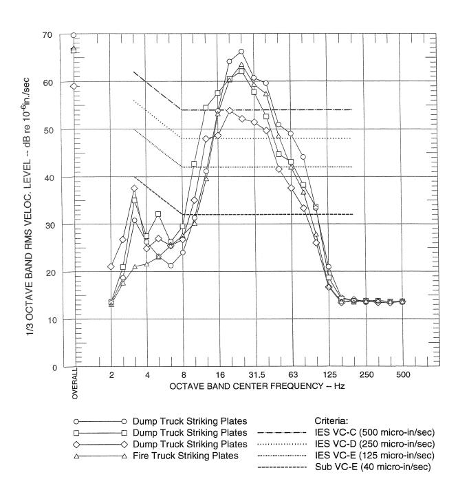
FIGURE 7A SINGLE-EVENT VIBRATION LEVELS AT POSITION 2 CH.1 - VERTICALLY PERPENDICULAR TO BEAM HALL STREET LEVEL - WEST
