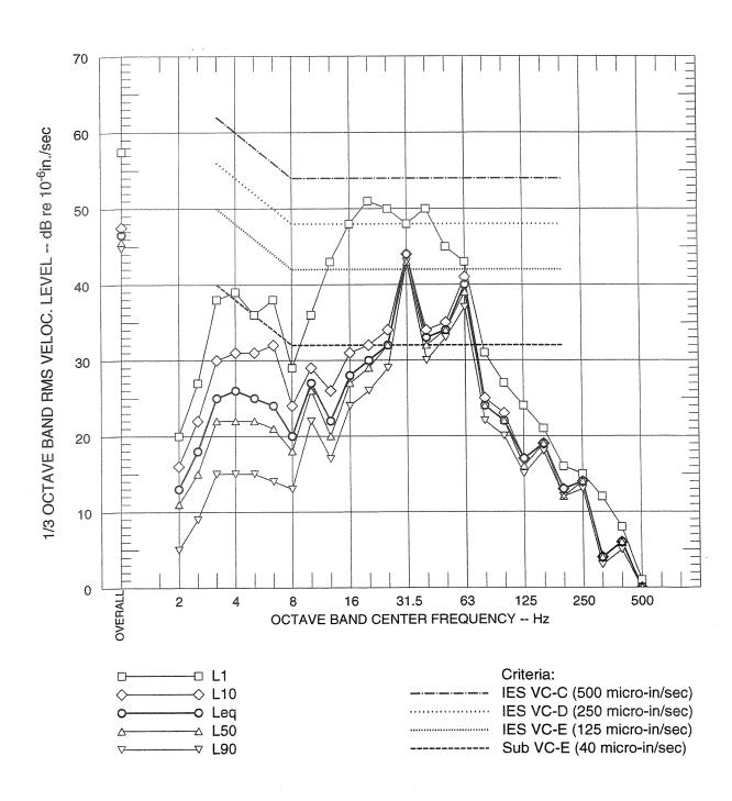
FIGURE 2D STATISTICAL VIBRATION LEVELS AT POSITION 2
