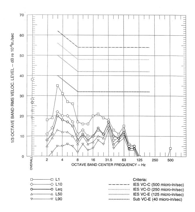
FIGURE 3C STATISTICAL VIBRATION LEVELS AT POSITION 3
