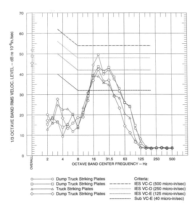
FIGURE 9B SINGLE-EVENT VIBRATION LEVELS AT POSITION 3 CH.2 - PARALLEL TO BEAM HALL LOWER LEVEL - INJECTOR HALL
