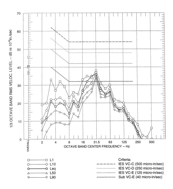
FIGURE 1A STATISTICAL VIBRATION LEVELS AT POSITION 1 CH.1 - VERTICALLY PERPENDICULAR TO BEAM HALL STREET LEVEL - EAST
