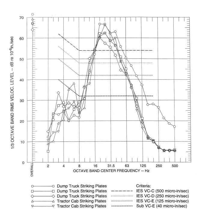
FIGURE 5A SINGLE-EVENT VIBRATION LEVELS AT POSITION 1 CH.1 - VERTICALLY PERPENDICULAR TO BEAM HALL STREET LEVEL - EAST
