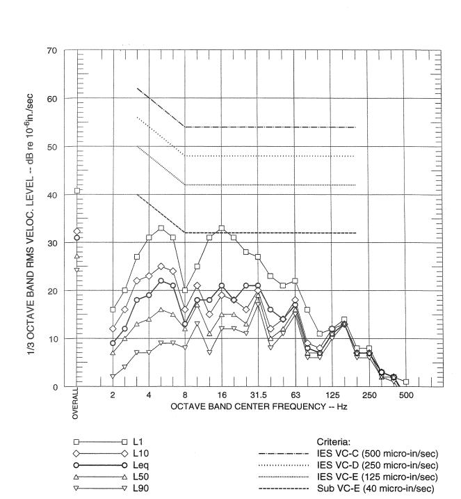
FIGURE 2B STATISTICAL VIBRATION LEVELS AT POSITION 2 CH.2 - PARALLEL TO BEAM HALL STREET LEVEL - WEST
