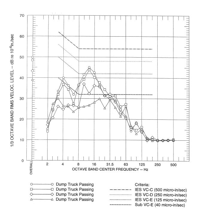
FIGURE 8D SINGLE-EVENT VIBRATION LEVELS AT POSITION 3
