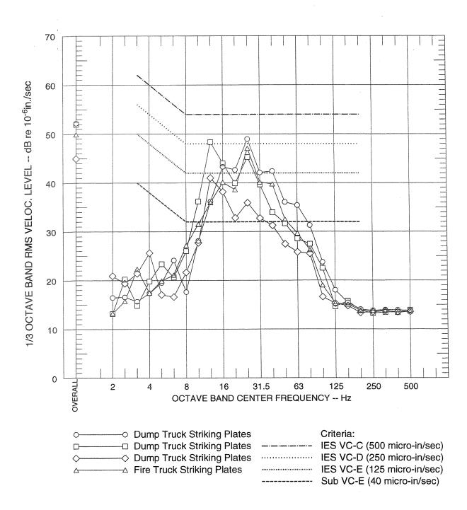
FIGURE 7B SINGLE-EVENT VIBRATION LEVELS AT POSITION 2 CH.2 - PARALLEL TO BEAM HALL STREET LEVEL - WEST
