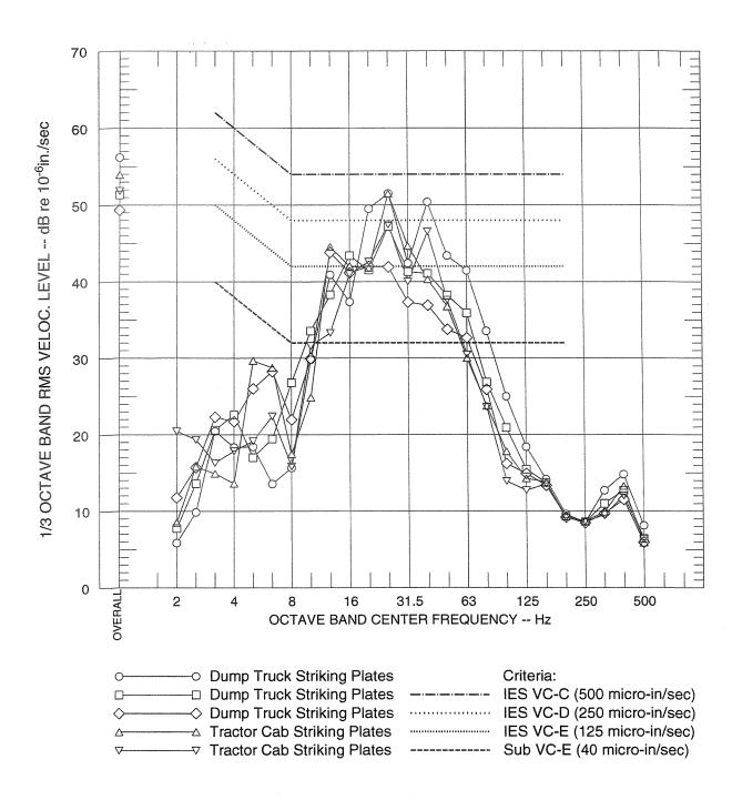
FIGURE 5B SINGLE-EVENT VIBRATION LEVELS AT POSITION 1 CH.2 - PARALLEL TO BEAM HALL STREET LEVEL - EAST
