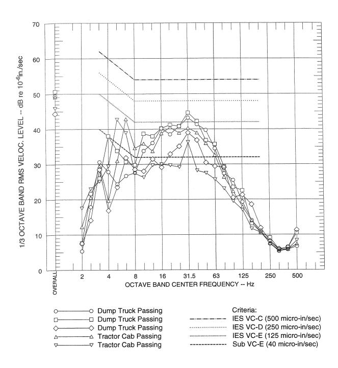
FIGURE 4A SINGLE-EVENT VIBRATION LEVELS AT POSITION 1 CH.1 - VERTICALLY PERPENDICULAR TO BEAM HALL STREET LEVEL - EAST
