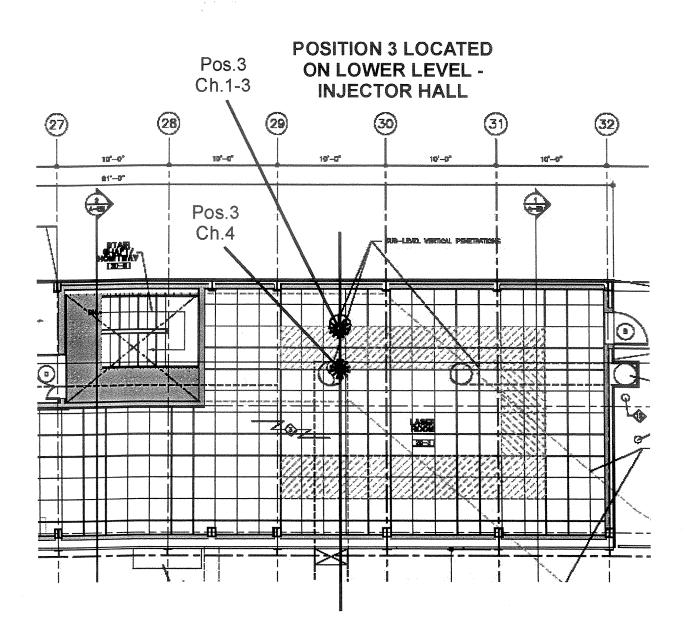
FIGURE A-2 SECTOR 20 VIBRATION MEASUREMENT POSITION - LOWER LEVEL (INJECTOR HALL) POSITION 3
