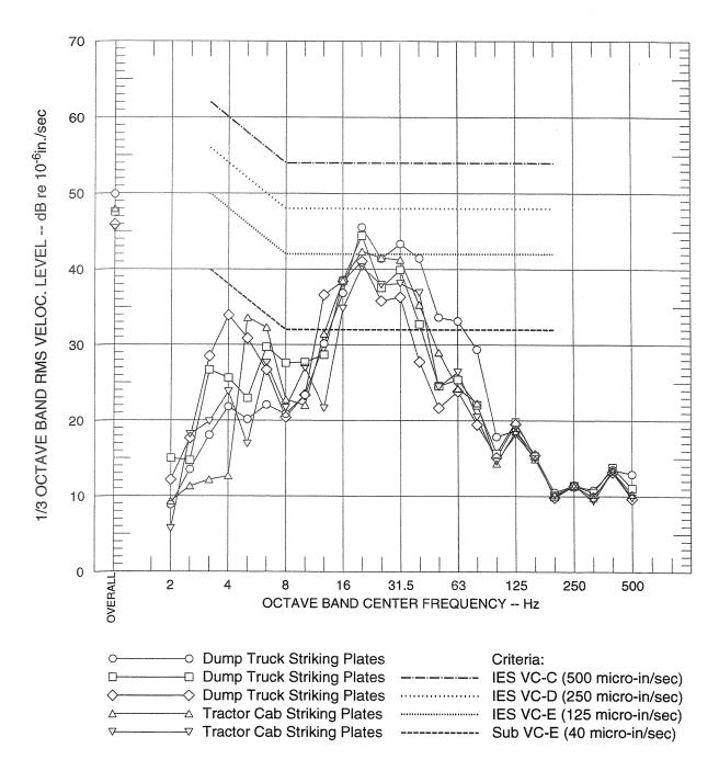
FIGURE 5C SINGLE-EVENT VIBRATION LEVELS AT POSITION 1
