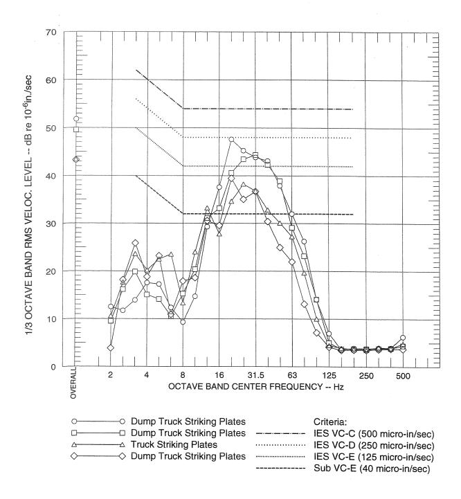
FIGURE 9C SINGLE-EVENT VIBRATION LEVELS AT POSITION 3
