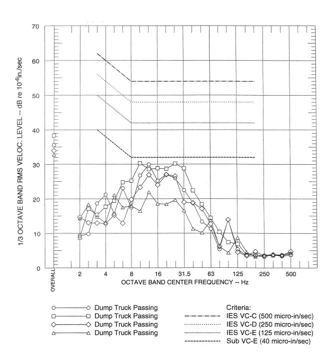
FIGURE 8B SINGLE-EVENT VIBRATION LEVELS AT POSITION 3 CH.2 - PARALLEL TO BEAM HALL LOWER LEVEL - INJECTOR HALL
