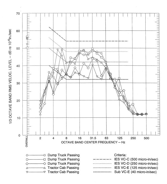
FIGURE 4D SINGLE-EVENT VIBRATION LEVELS AT POSITION 1
