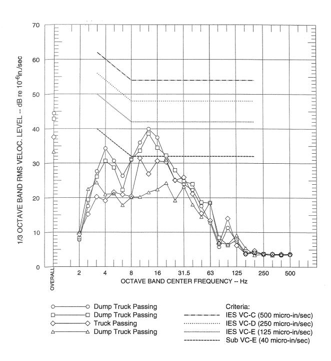
FIGURE 8A SINGLE-EVENT VIBRATION LEVELS AT POSITION 3 CH.1 - VERTICALLY PERPENDICULAR TO BEAM HALL LOWER LEVEL - INJECTOR HALL
