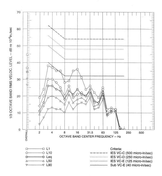
FIGURE 3D STATISTICAL VIBRATION LEVELS AT POSITION 3
